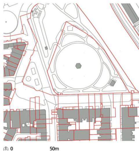
Figura 4. Sobreposição da propriedade fundiária sobre a forma construída em parte da cidade de Bath, na Inglaterra, mostrando um direito de passagem ou servidão. Cartografia de base © Crown Copyright and Database Right (2017). Ordnance Survey (Licença Digimap). Dados dos Land Registry Index Polygons licenciados sob a Open Government Licence v3.0 (fonte: reprodução do artigo original)
