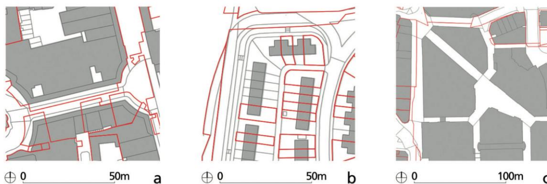
Figura 3. Sobreposição da propriedade fundiária (em vermelho) à forma construída, em parte da cidade de Bath, Inglaterra. (a) Múltiplos lotes/edificações pertencentes, em sua maioria, a uma única propriedade (metade superior) e diferentes partes de uma mesma edificação pertencentes a proprietários distintos (metade inferior). (b) Edificações, lotes e espaços viários pertencentes a múltiplos proprietários privados. (c) Propriedades públicas e privadas coexistem em decorrência da legislação “right-to-buy”. Cartografia de base © Crown Copyright and Database Right (2017). Ordnance Survey (Licença Digimap). Dados dos Land Registry Index Polygons licenciados sob a Open Government Licence v3.0 (fonte: reprodução do artigo original)
