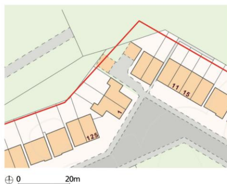
Figura 5. Um limite de propriedade (em vermelho) e o limite físico (em preto). Cartografia de base © Crown Copyright and Database Right (2017). Ordnance Survey (Licença Digimap). Dados dos Land Registry Index Polygons licenciados sob a Open Government Licence v3.0 (fonte: reprodução do artigo original)
